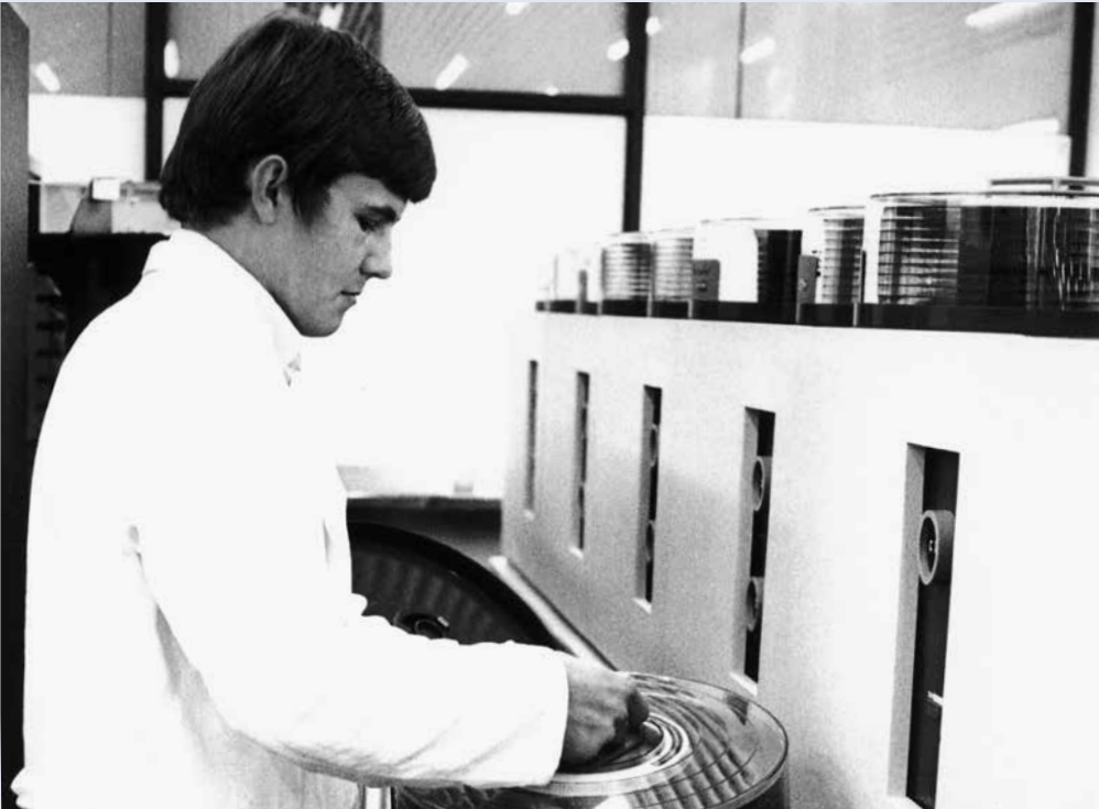
In einer Plattenspeichereinheit konnten bis zu acht Magnetplattenspeicher gleichzeitig verwendet werden. Im Bild Johann Knöferl.
